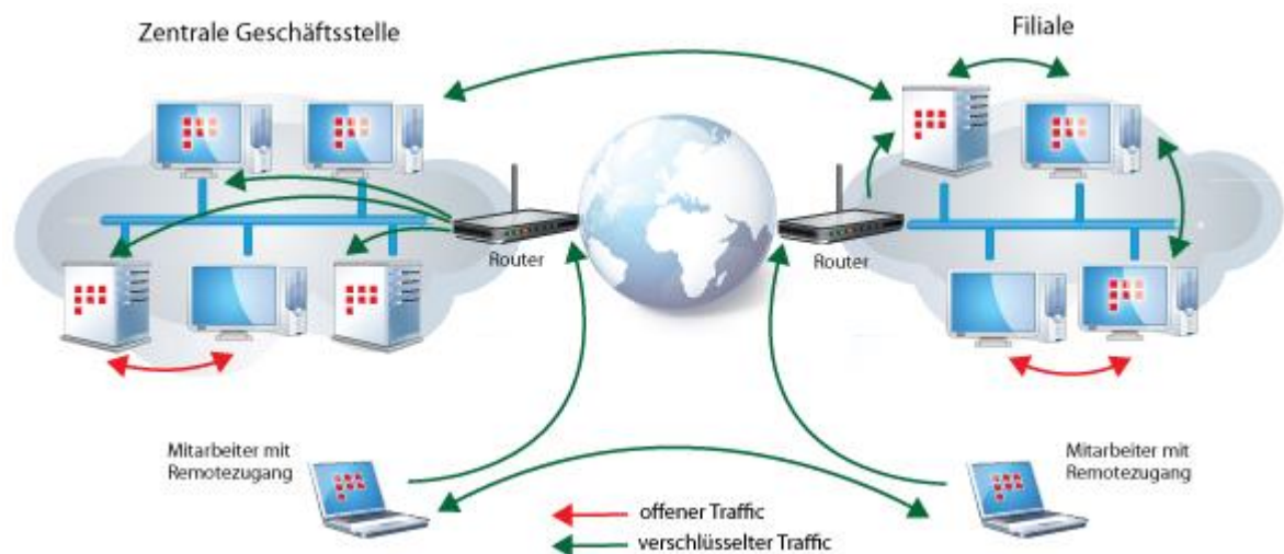
Abbildung 9. Aufbau eines VPN-Netzwerks auf Basis der ViPNet-Technologie
